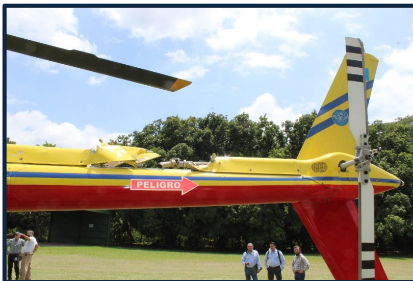
Fotografía No. 06 Vista del eje cortado por el impacto de las aspas del rotor principal.
