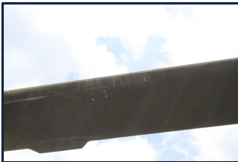
Fotografía No. 07 Vista de la sección del asa que impactó con el botalón de cola.
