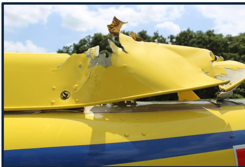
Fotografía No. 09 Vista lateral izquierda del botalón dañado.
