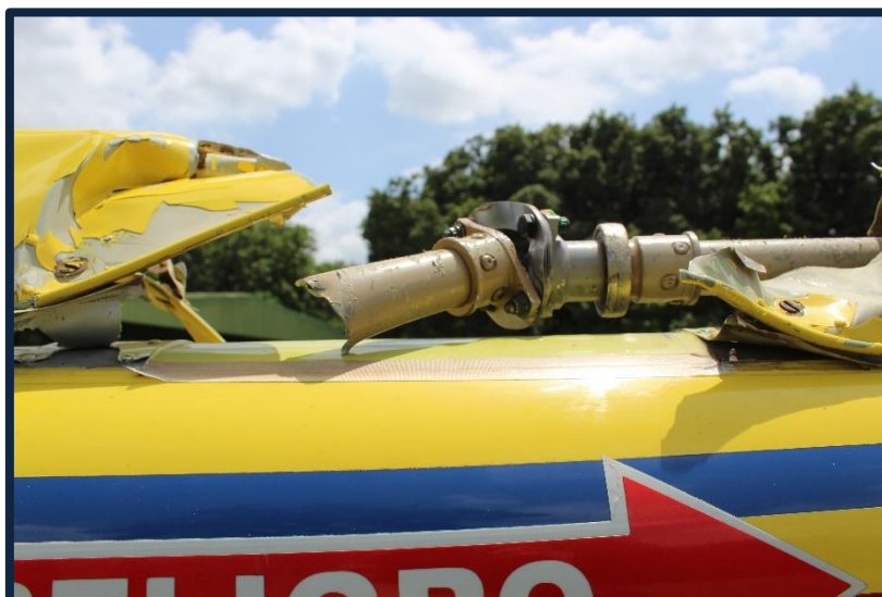
Fotografía No. 10 Vista del daño en el botalón y eje de transmisión de potencia.
