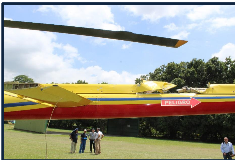
Fotografía No. 05 Vista del botalón dañado.
